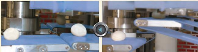
小物製品の高速生産時、製品の着地を安定させ、列を乱さずに生産できる「ベルト2本掛け仕様」を選択できます。また、コンベヤーの上下機構を独自に制御できるため、美しい形状に包あん成形できます。
