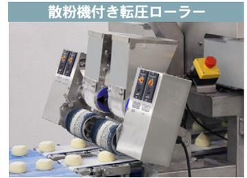
コンベヤー上に二次成形オプション 2列を倍の4列に、4列を倍の8列を搭載し、段階を追って美しく成形にします。倍列効果により、後工程の自由度が高まります。
