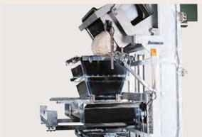
ドウボックスリフターで生地供給機に投入された生地は、適量ずつ自動的に分割されたV4 ツインデバイダーのV ホッパーへ供給されます。
