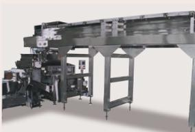
ドウボックスに入れた生地を生地供給コンベヤーへ投入します。先端に装着されたカッター（オプション）で、大玉分割しながらV4 ドウフィーダーのホッパーに生地を自動供給します。
